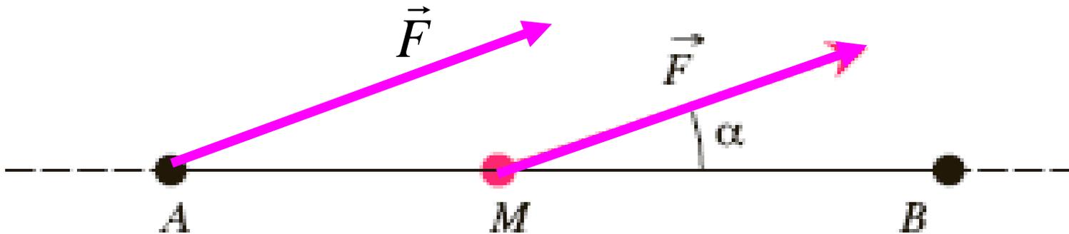
Le travail mesure l'énergie nécessaire pour déplacer un corps en lui appliquant la force  $\vec{F}$
