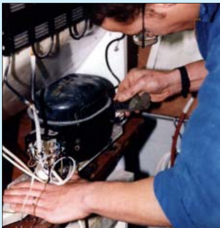
Atelier Envie : les composants les plus polluants sont extraits des vieux réfrigérateurs.
