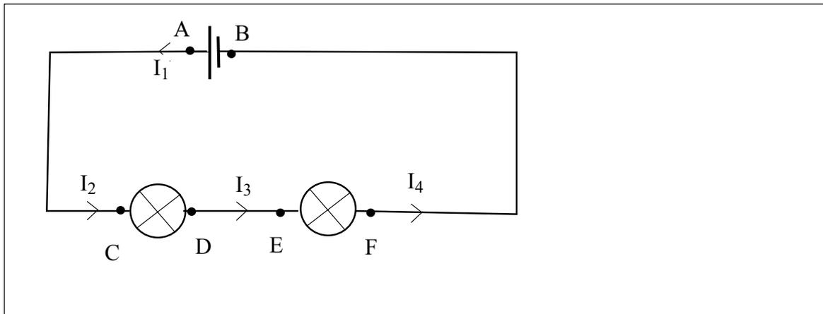
Nous allons mesurer les intensités  $I_1$  en sortie de générateur et  $I_2$  à l'entrée de la première lampe, juste avant le point C.
