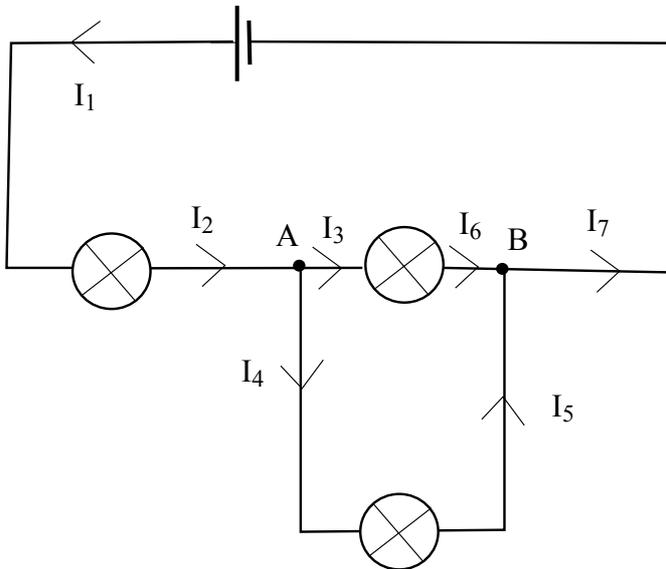
$I_1 = 0,15 \text{ A}$  et  $I_4 = 0,05 \text{ A}$ . Calculer  $I_2$ ,  $I_3$ ,  $I_5$ ,  $I_6$  et  $I_7$  (justifier à chaque fois à partir d'une loi du courant)
