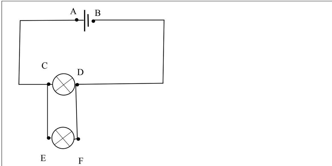
.. prenaient le fil qui va de C à E, faisaient un nœud sur le fil qui va de C à A, et de même faisaient un nœuds sur le fil qui va de D à B, avec le fil qui va de D à F. C'est pourquoi aujourd'hui encore, quand dans un circuit électrique, on trouve au moins trois fil partant du même point, on appelle ce point «nœuds» électrique.
